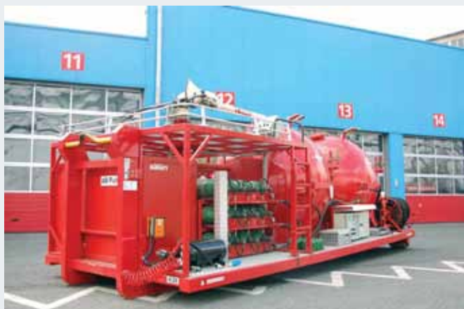
Slika 2. Ugradbeni sustav za gašenje prahom 2x3000 kg
